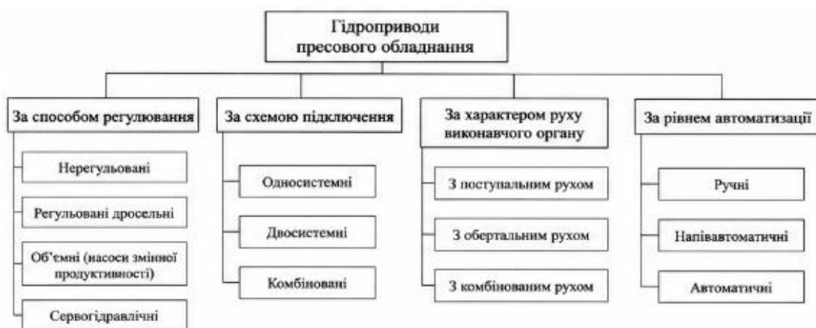
Рисунок 1.4 – Класифікація гідроприводів пресового обладнання.
