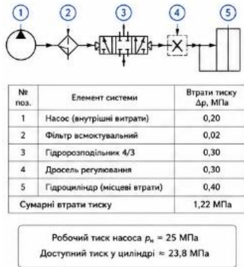
Рисунок 2.4 – Схема втрат тиску в елементах гідросистеми.
