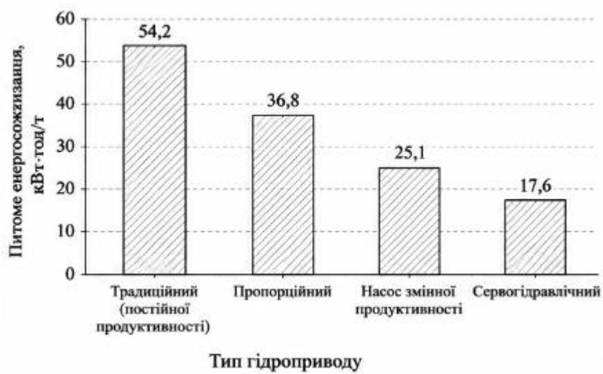
Рисунок 1.5 – Порівняння енергоспоживання різних типів гідроприводів.
